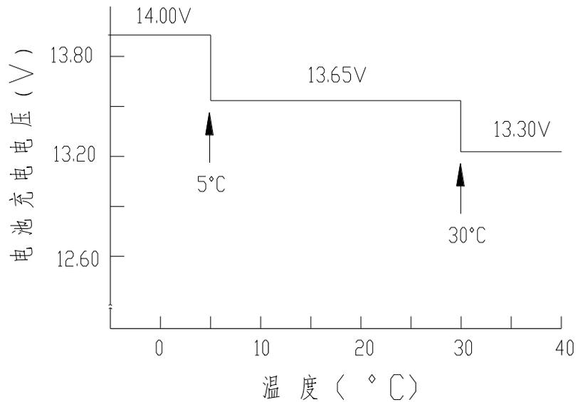
2V 系列纳米电池：（温度在 25℃时，电池的浮充电压为：2.23±0.1V/台）
